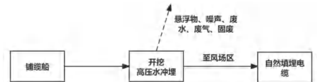
图 3.2.1-2 海底电缆施工工序和产污环节图
